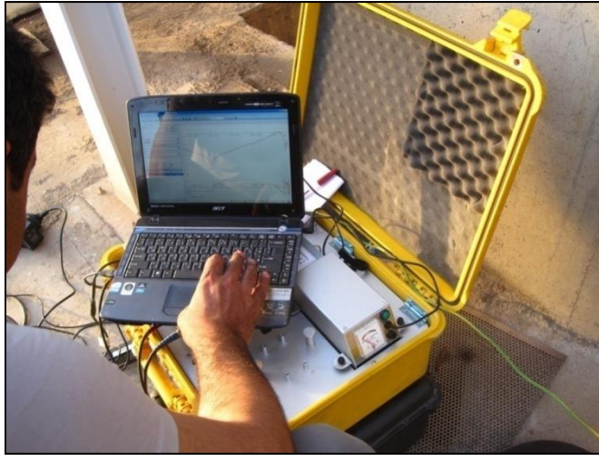
شکل ۳-۸-۱۰- تجهیزات اندازه‌گیری FRA
